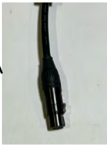
メインケーブル側接続コネクタ部
