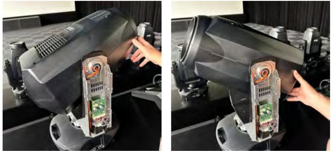
次に、PAN制限用のパーツを取り付けます。穴あきレングを希望の角度に合わせてネジ穴に置き、TX10ネジ2本で固定します（写真参照）。角度の概要は次のページをご覧ください。
