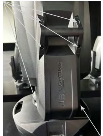
次のステップでは、傾き制限用の回転部品を取り付けます。これを行うには、ピンセットやノーズプライヤーを使ってヘッドとアームの間に回転部品を挿入し、後ろから反応する穴に入れ、トルクスTX20ドライバーでネジを締めます。この手順を2つ目のストップについても同様に繰り返します。例えば、 $-66^{\circ}$ から $66^{\circ}$ に制限された動きを得るには、1つ目のストップの穴6と2つ目のストップの穴23にストップを入れる必要があります。
